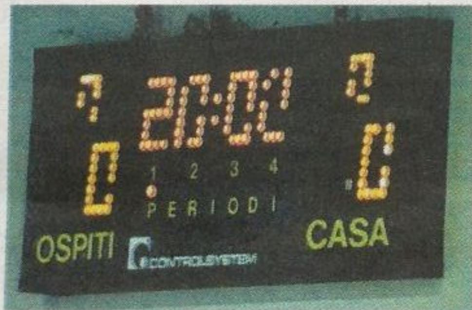
subito guasti e spegnimenti che rendono a tratti impossibile la lettura delle cifre rappresentate. Qual è dunque la soluzione? Che sia forse necessario un nuovo tabellone? Quasi certamente no, con ogni probabilità basterà sostituire i led danneggiati con delle luci funzionanti ed il tabellone tornerebbe al suo antico splendore. I molti, calorosissimi, tifosi biancorossi, che frequentano assiduamente il palazzetto, ne sarebbero senza dubbio felici.
